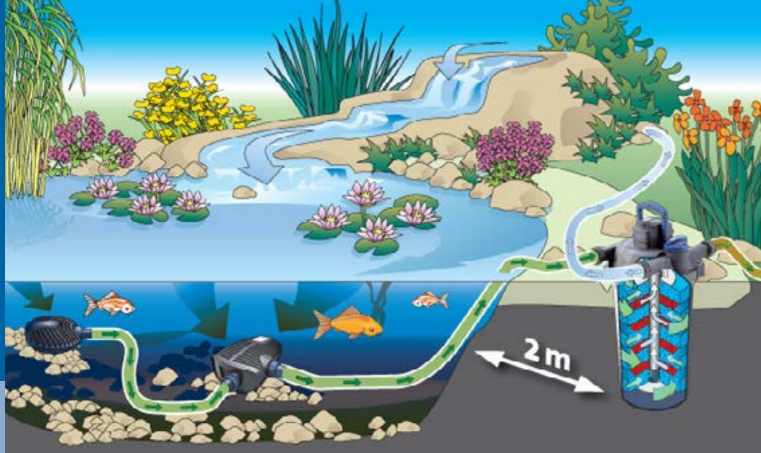
Схематическая диаграмма: Насос для фильтров и ручьев AquaMax Eco (ППО) в сочетании с напорным фильтром OASE FiltoClear (ППО)
