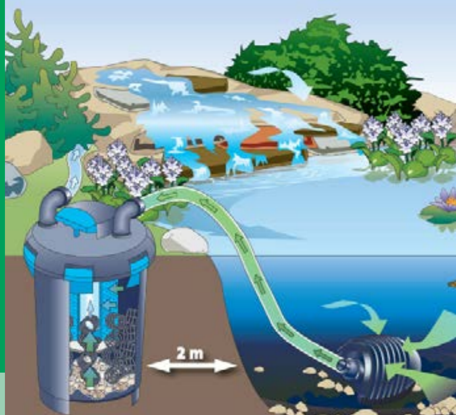
Схематическая диаграмма: Установка напорного фильтра - комбинация фильтра и насоса для ручьев
