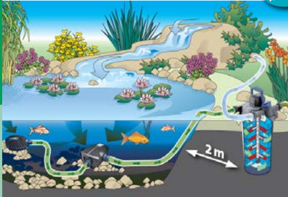
Схематическая диаграмма: Напорный фильтр FiltoClear в сочетании с фильтром и насосом для ручьев
