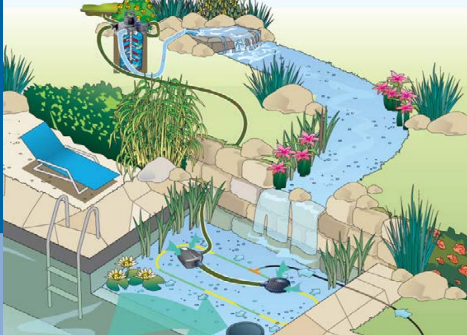
Схематическая диаграмма: Использование насоса для фильтров и ручьев AquaMax Eco Premium 12 В (ППО) в сочетании с напорным фильтром OASE FiltoClear (ППО)
